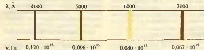
Схема спектра видимого света. Слева фиолетовый конец спектра, справа красный. Наверху длины волн в ангстремах ( $1\text{ Å} = 10^{-8} \text{ см}$ ), внизу частоты в герцах. Энергии, падающие на выделенные четыре полоски спектра, относятся, как значения спектральной функции —  $f(0.120 \cdot 10^{15}) : f(0.096 \cdot 10^{15}) : f(0.080 \cdot 10^{15}) : f(0.067 \cdot 10^{15})$ .
